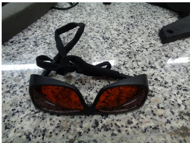
Figura 37: Gafas de protección contra radiación láser 532 nm
