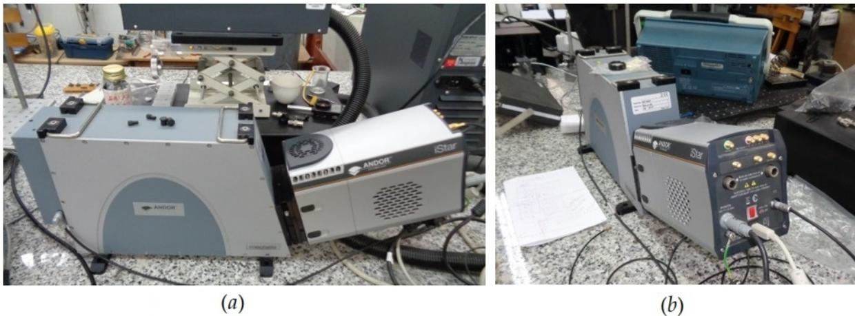
Figura 34: Espectrógrafo y cámara ICCD. (a) Espectrógrafo Andor MECHELLE 5000 y Cámara ICCD Andor iStar. (b) Parte posterior de cámara ICCD
