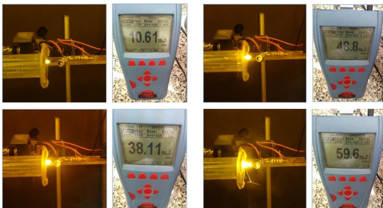
Figura 46: Imágenes de plasmas obtenidos en la muestra secundaria de titanio mediante ablación láser a diferentes energías por pulso láser.
