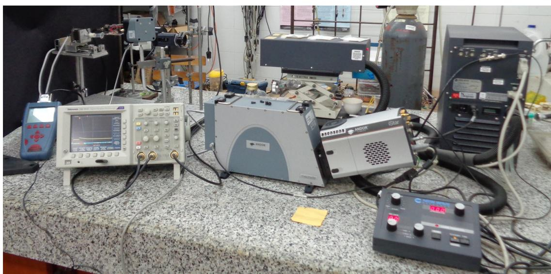
Figura 43: Montaje experimental en laboratorio para la observación del plasma-láser de titanio y captura del espectro en el tiempo
