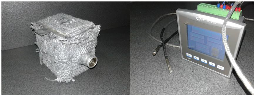
Figura 3.9: A la izquierda: modelo básico de cavidad, a la derecha: sensores de temperatura y plc Unitronics V350
