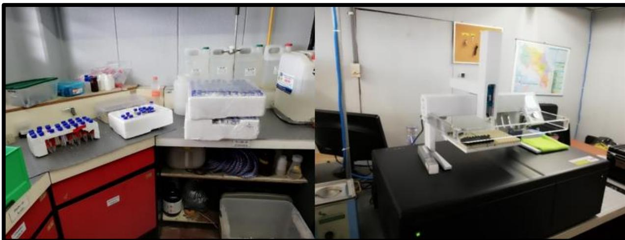
*Ilustración 7 Preparación de muestras y equipo utilizado para la determinación de la concentración isotópica de las muestras.*
