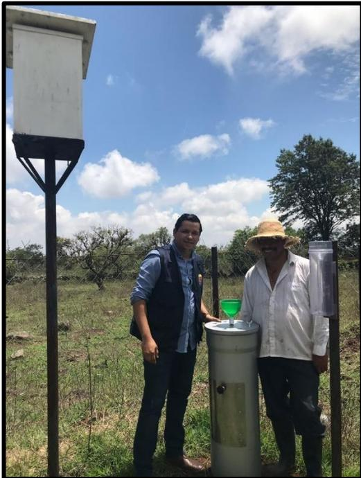
*Ilustración 6 Revisión y mantenimiento a equipo en estación de monitoreo y recolección de agua lluvia en el Cerro de Hula.
