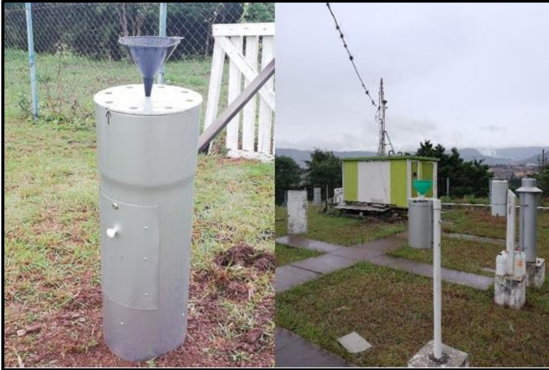
*Ilustración 5 Instalación de equipo de recolección de muestras de agua lluvia en la UNAH.
