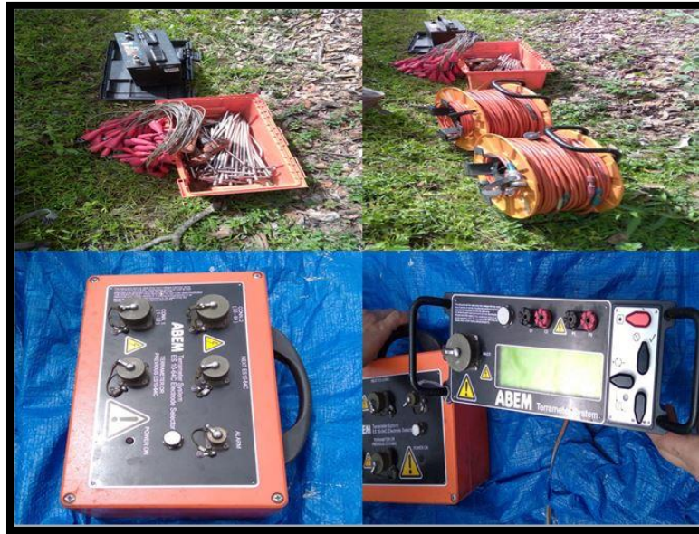
Ilustración 17: Equipo Geofísico utilizado en campo para la elaboración de sondeos geofísicos.
