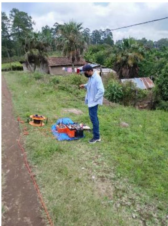
*Ilustración 50. Levantamiento geofísicos, método de tomografía eléctrica.*
