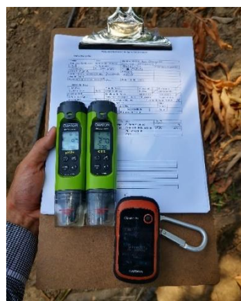
10c) Equipo utilizado para toma de parámetros fisicoquímicos y coordenadas GPS.
