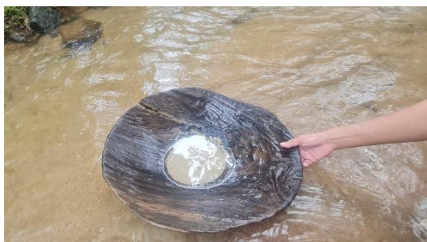
Figura 29: Batea utilizada para recuperación de oro amalgamado en ríos.
