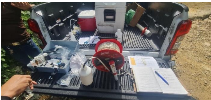
Figura 8: materiales y equipo utilizado para muestreo y análisis in-situ.
