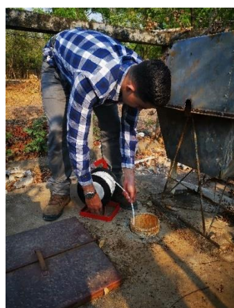
10a) Medición de nivel freático en pozo malacate en El Naranjal.
