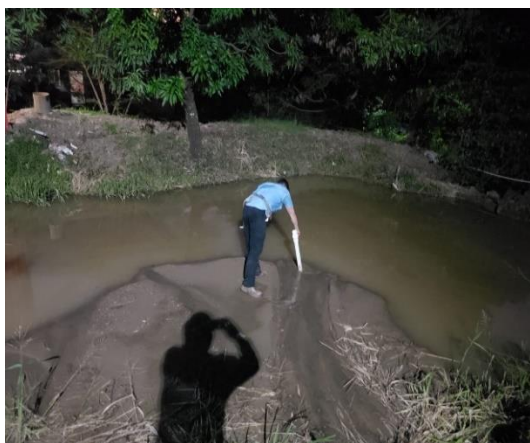
9a) Toma de muestra de sedimentos en laguna CHR01 utilizando core de PVC.
