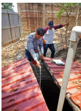
10b) Medición de nivel freático en pozo malacate en Los Chagüites.
