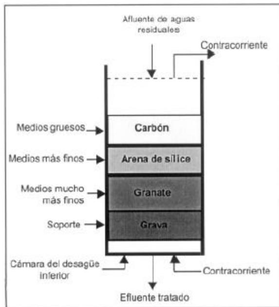
Figura 2. Diagrama del sistema de filtración con medios múltiples (EPA, 1995)
