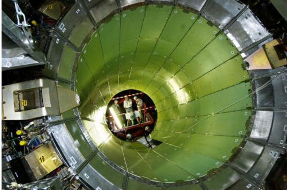
Figura 2.6: Calorímetro electromagnético que se encuentra en el experimento CMS en CERN.
