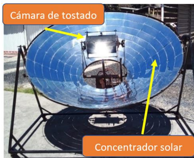
Figura 5.1 Concentrador solar de Fresnel y la tostadora de café
