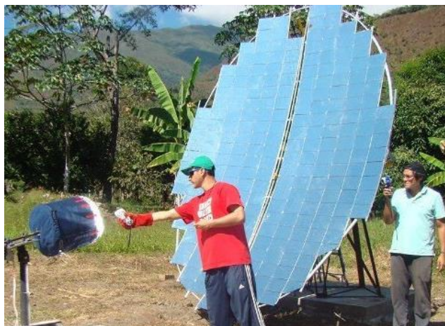
Figura 2.4 Concentrador solar tipo Reflector Scheffler del proyecto Intikallana
