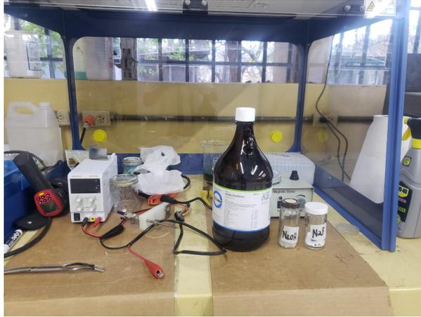
Figura 3.4: Equipo y ácidos para el electropulido y ataque de muestras
