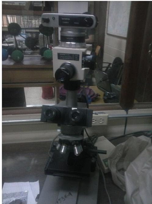
Figura 6.8: Microscopio Óptico Metalográfico
