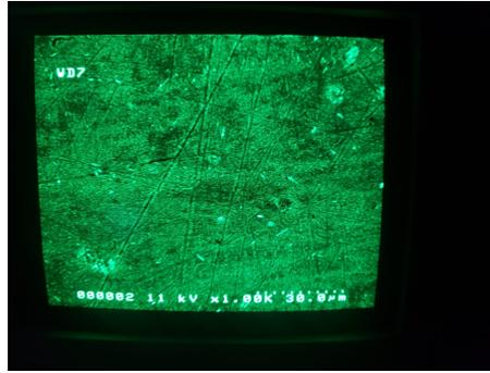
Figura 6.14: Muestra mala debido a la presencia de rayas en la estructura
