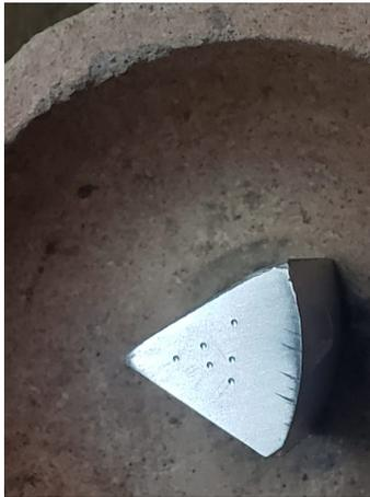
Figura 6.6: Probeta ensayada con marcas del durómetro
