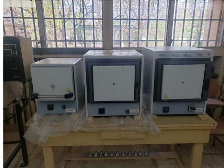
Figura 3.3: Hornos eléctricos para el proceso de investigación
