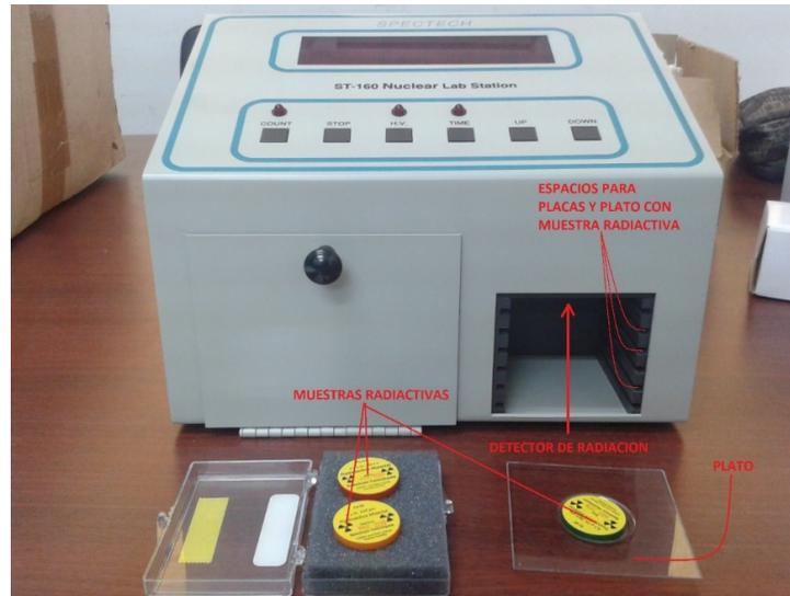
**Figura 4.1:** Medidor SPECTRUM TECHNIQUES ST-160
