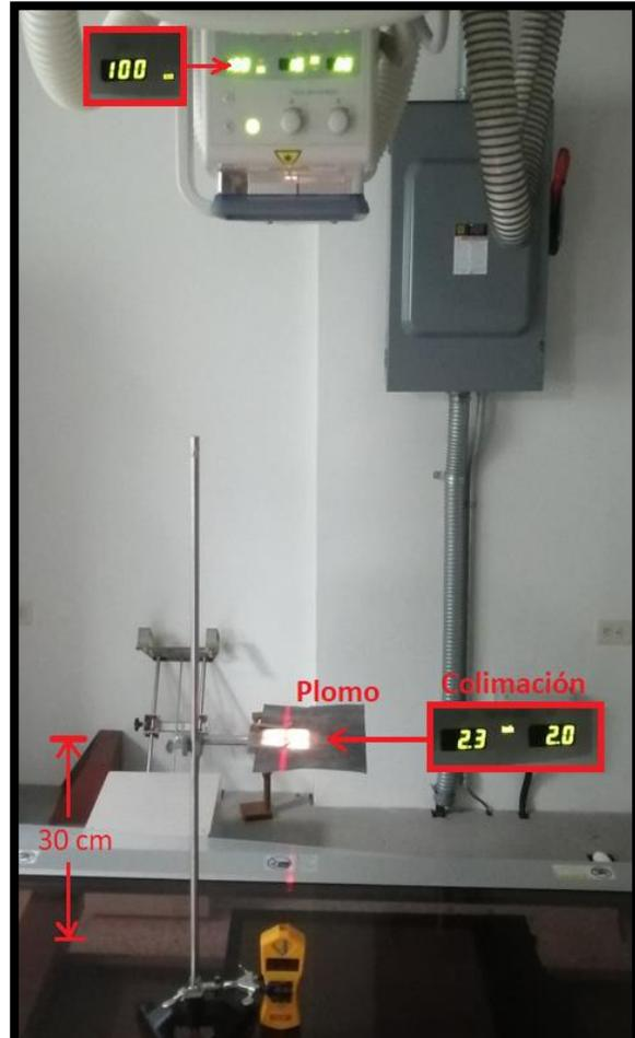
*(b) Barrera de plomo colocada a 30 cm del detector y a 1 metro de la fuente. Área de colimación 2.3 x 2 pulgadas.*
