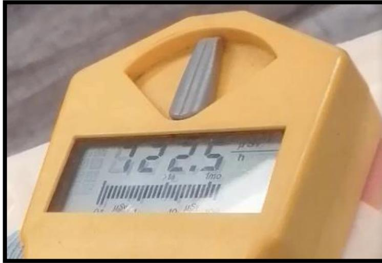
Para conocer cuanta radiación llegaba después del vidrio plomado se colocó en Geiger al otro lado del vidrio:
