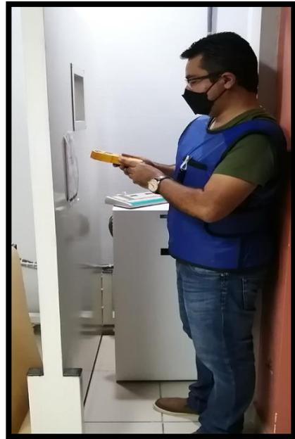
Para medir la radiación al otro lado de la mampara se irradió 3 veces el fantoma para contar con cierta cantidad de radiación dispersa.
