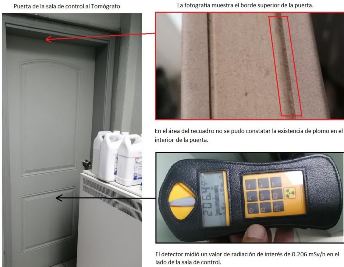
**Conclusión:** se debe de instalar una lámina de plomo de espesor como mínimo de 1.5 mm en la puerta de la sala de control del tomógrafo para garantizar la protección de técnicos y doctores.
